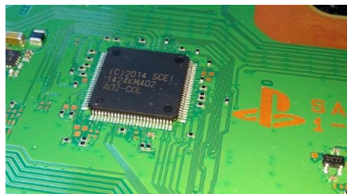
Componente (SMD) com muitos contatos
