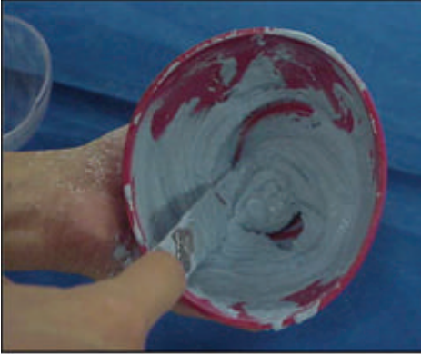
Figura 45: Espatulação do gesso.
