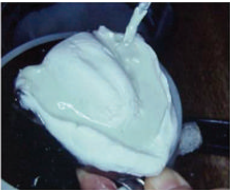
Figura 47: Vazamento da primeira camada de gesso sobre o molde.
