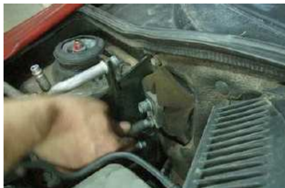
Válvula de expansão removida
