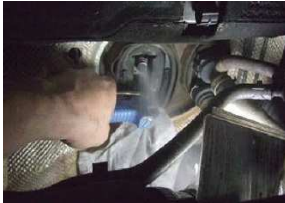
Fazer a limpeza com nitrogênio comprimido
