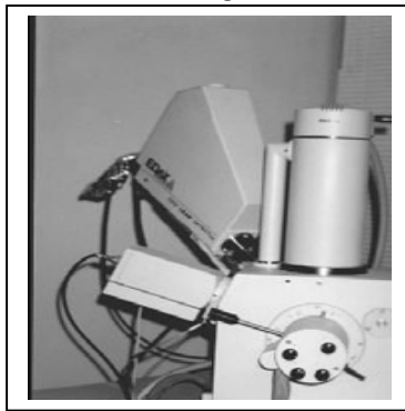
Figura 1.7 - Vista geral de um MEV modelo XL30 da Phillips
