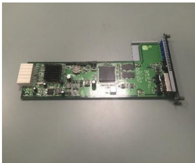
Armazenamento INCORRETO da placa
