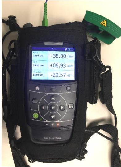
Medição de potência na saída da OLT
