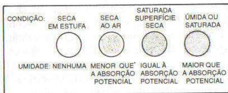
Figura 3 – Condições de umidade dos agregados
