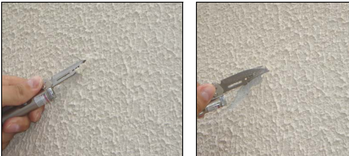
Figura 53 - Avaliação da aderência pelo método do entalhe
