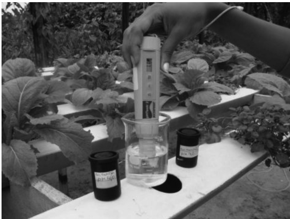
Figura 8. — Peagâmetro portátil sendo usado para aferição do pH de uma solução nutritiva.
