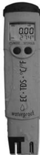
Figura 9. — Condutivímetro portátil, com correção da temperatura e conversão das leituras para sólidos solúveis totais (TDS).
