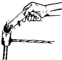
Com o "ignitor" (acendedor especial), faz-se a ignição. Assim, inicia-se o processo de fusão dos metais.
