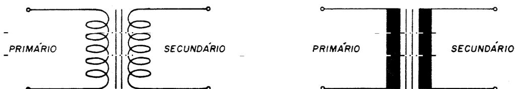
Os traços colocados no símbolo entre as bobinas do primário e secundário, indicam o núcleo de ferro laminado. O núcleo de ferro é empregado em transformadores que funcionam em baixas frequências (50 Hz, 60 Hz, 120 Hz).
