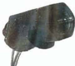
O módulo de injeção utiliza a frequência do sinal gerado do sensor de velocidade para: identificar o veículo parado ou em movimento, enriquecimento do combustível durante a aceleração, corte do combustível (cut-off), controle da rotação em marcha lenta, permite em alguns tipos de injeção que o ventilador do radiador seja desligado em velocidades elevadas, acionar a embreagem do conversor de torque em veículos equipados com transmissão automática. Ainda atua
