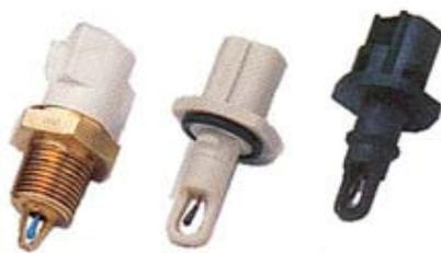
A medição da temperatura do ar aspirado pelo motor é feita pelo sensor de temperatura colocado antes do corpo de borboletas. Normalmente são usados dois fios; um que vem tensão do módulo de injeção e outro de retorno ou referência. O sensor de temperatura é composto por um termistor do tipo NTC (Negative Temperature Coefficient) quanto maior a temperatura menor a resistência elétrica. O sinal elétrico é enviado ao
