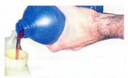
O fluido da direção hidráulica, além de sua função principal que é pressurizar o sistema, também tem a função de lubrificar os mecanismos. Por isso, é importante a periódica verificação do nível e aspecto do fluido do sistema e também obedecer o prazo para troca.
