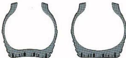
Pneu vazio à esquerda e cheio à direita, apresentando maior área de contato da banda de rodagem.
