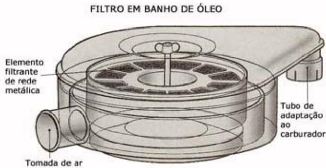
A rede metálica, o tipo mais simples de filtro de ar, consiste numa rede de malha larga impregnada de óleo antes de ser colocada no filtro. A sua duração é praticamente ilimitada, desde que a rede seja desmontada periodicamente para limpeza e impregnação de óleo. Existia uma infinidade de modelos de filtros de rede metálica, alguns dos quais apresentavam uma câmara idêntica à de um silencioso de escapamento, a fim de reduzir o ruído.
