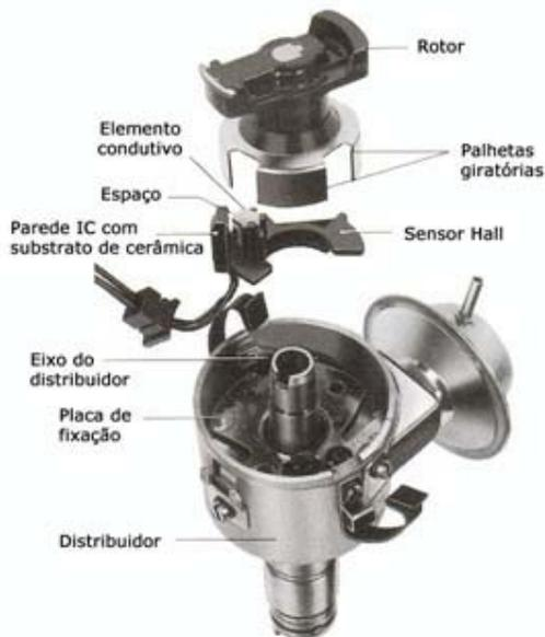
O sensor hall identifica a posição do virabrequim e envia esta informação ao módulo de injeção eletrônico, em forma de sinal retangular. O sinal retangular do sensor hall é utilizado pelo módulo de injeção eletrônica para a determinação do ângulo de ignição com base nas rotações. Sem este sinal de referência não é possível regular com precisão o ponto da ignição.
