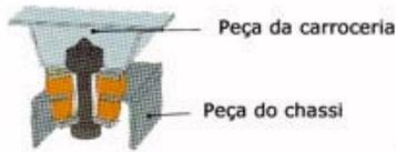
Corte em que é visível a fixação da carroceria ao chassi por meio de parafusos
