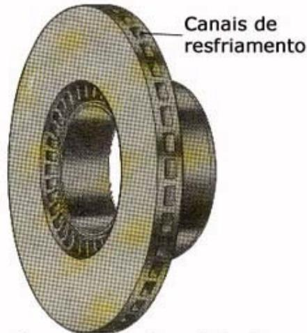
No entanto, nos veículos de competições e de elevada potência, em que as temperaturas geradas são muito elevadas, os discos necessitam de uma ventilação adicional a fim de se manterem arrefecidos e para aumentar a sua área e facilitar o resfriamento, o disco pode ser fundido sob a forma de dois pratos metálicos, em vez de um só prato espesso, ligados em forma a permitir uma eficaz circulação do ar entre os discos e conseqüente esfriamento rápido dos pratos.
