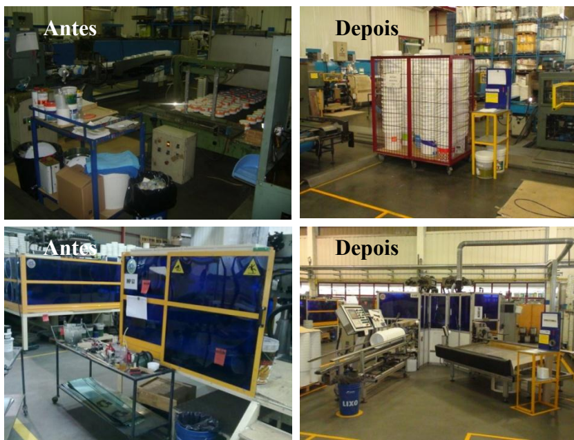
Figura 26 - Secção de trabalho da Serigrafia (em cima) e Offset (em baixo) antes e depois da implementação da ação 5'S – Neorelva Plásticos – Polo 2
