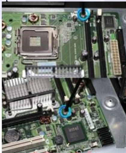
Parafusar com muito cuidado para não danificar a placa mãe
