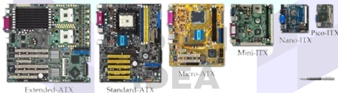
Principais padrões de placas-mãe — imagem: Via Technologies
