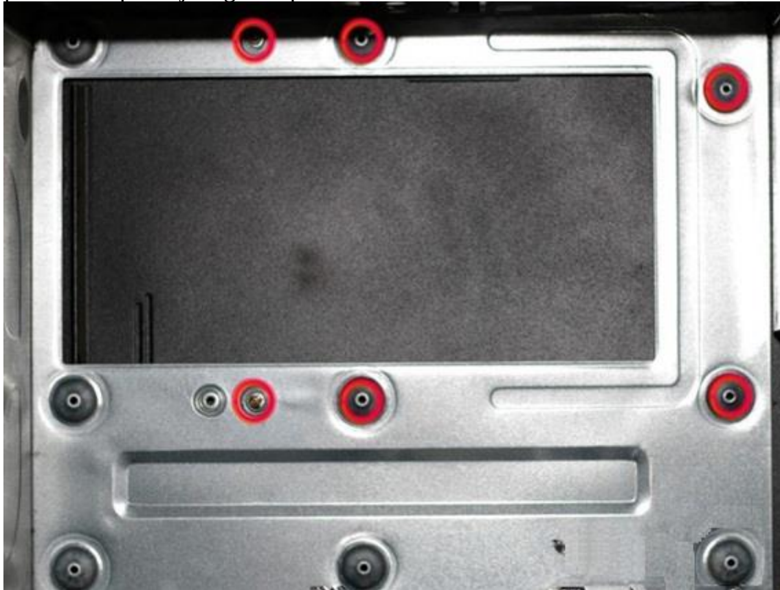
Local exato onde faremos a fixação da placa mãe
