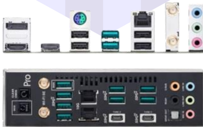
Conectores traseiros de duas placas-mãe (a última vem com os conectores protegidos) — imagens originais: Asus
