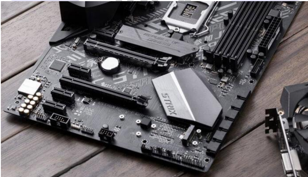
Slots PCI Express em uma placa-mãe — imagem original: Asus
