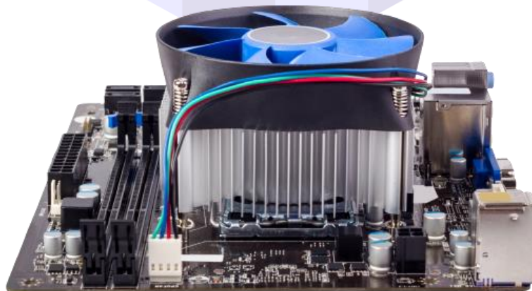
Área do processador (que está abaixo da ventoinha e dissipador) e slots de RAM
