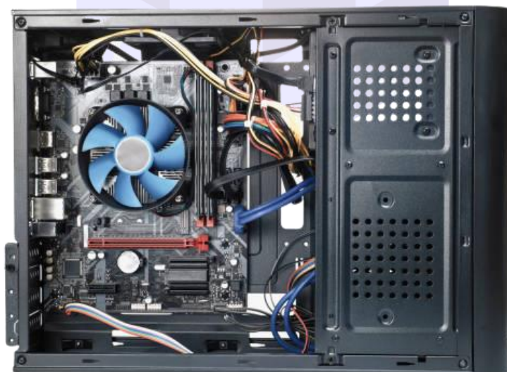
Placa-mãe montada em um computador aberto
