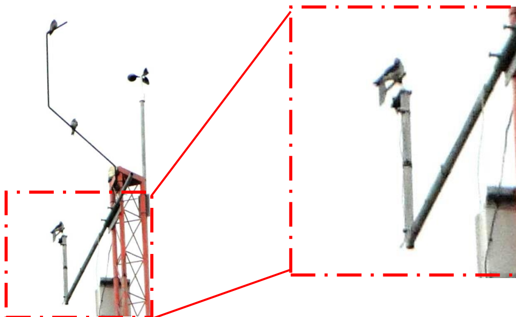
FIGURA 39. Medidor de direção com dado alterado por pássaro.
