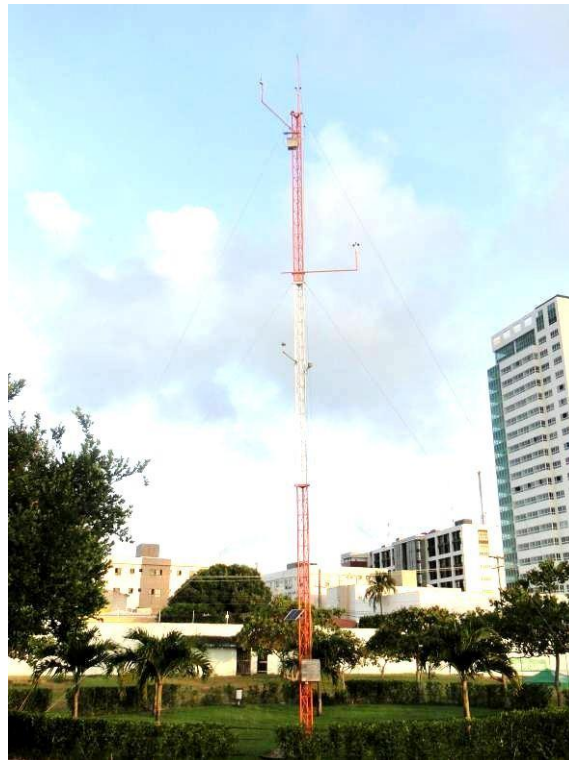
FIGURA 40. Torre anemométrica educacional do CTGAS-ER.
