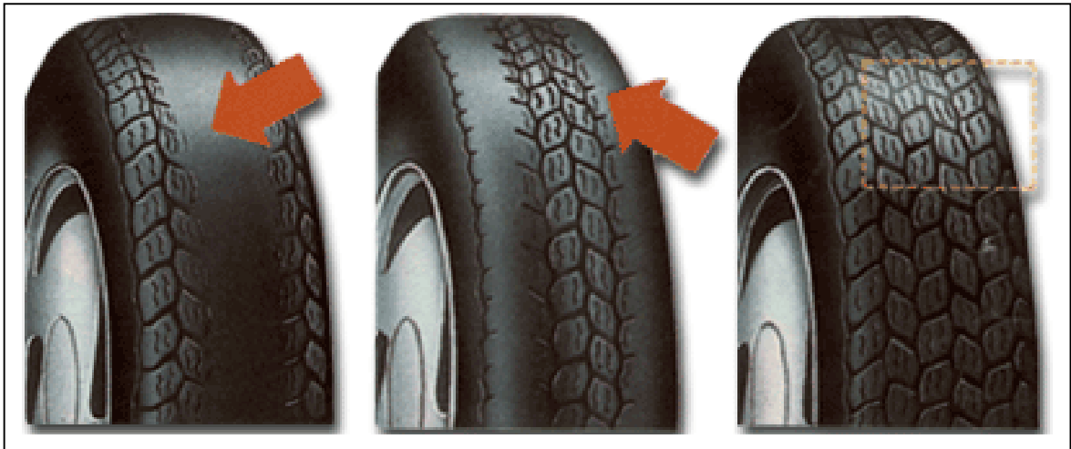
Pressão acima da recomendada Pressão abaixo da especificada Pressão Recomendada
