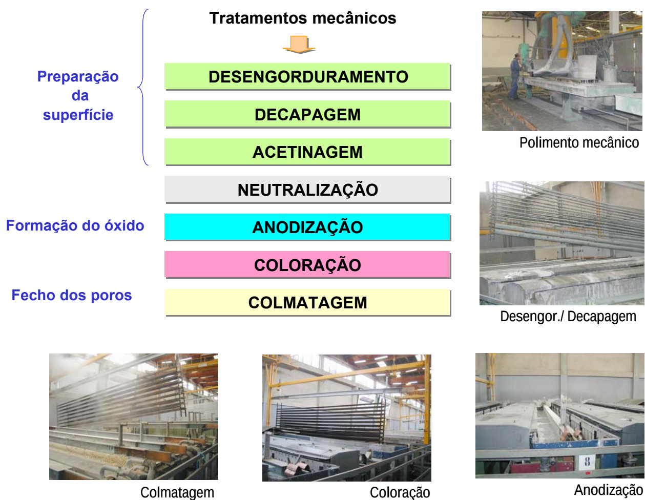
Figura 3 – Processo de anodização de perfis de alumínio – Principais etapas
