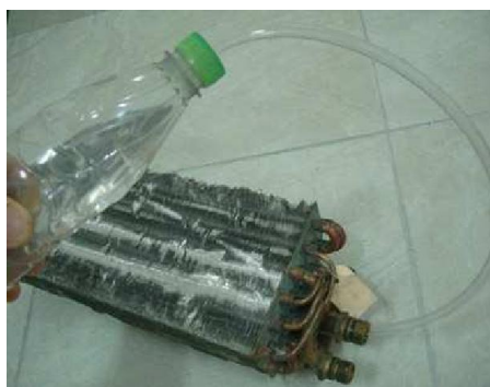
Ferramenta artesanal com o fluido R-141B
