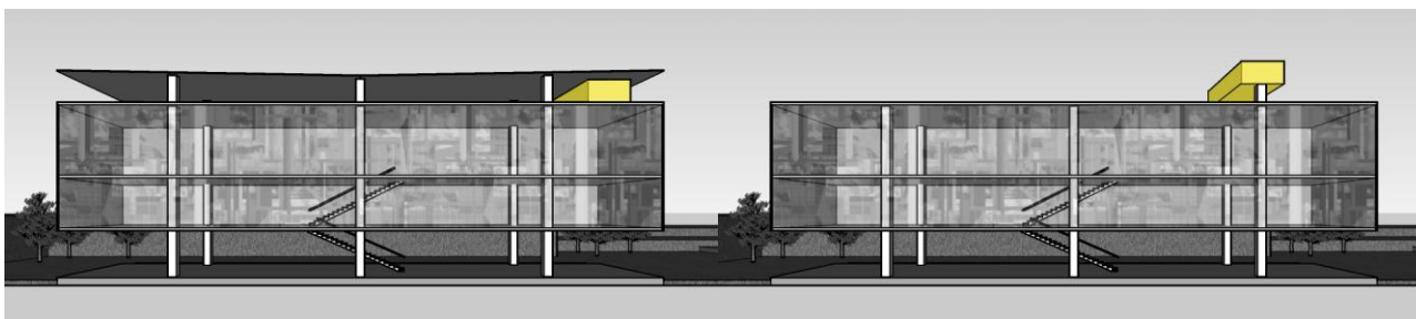
Figura 1 – localização do reservatório de AP superior, abaixo da cobertura. Figura 2- localização do reservatório de AP superior, acima do forro.
