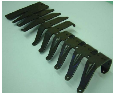
Produção de um elemento de fixação por estampo progressivo
