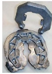
Forjamento de talheres e peça automotiva
