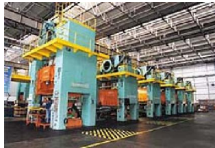
Prensa industrial utilizada na estampagem de peças automotivas
