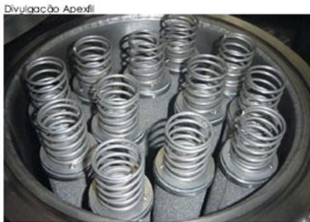
Filtro de superfície com telas metálicas
